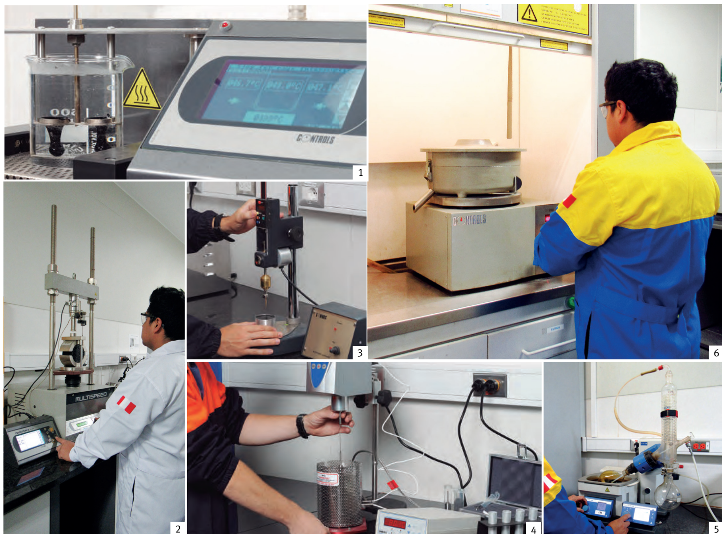
1- Ensayo de punto de reblandecimiento del betún / Softening point of bitumen 2- Ensayo Marshall / Marshall test 3- Ensayo de penetración de materiales bituminosos / Penetration of bituminous material 4- Viscosidad de Brookfield/ Brookfield viscosity 5- Recuperación del betún por evaporación rotativa / Recovery of asphalt through rotary evaporation 6- Porcentaje de betún por centrifugación / Percentage of bitumen by centrifuging
